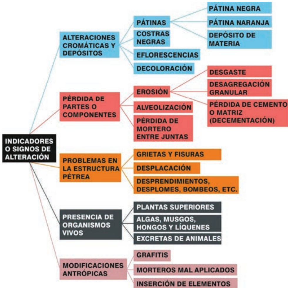
Figura 5. Clasificación de los indicadores de alteración presentes en el Arsenal
